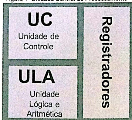
Figura 1- Unidade Central de Processamento
