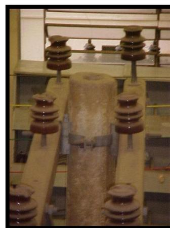
Figura 2.5: Poste com Vazado Cilíndrico em seu Interior.
