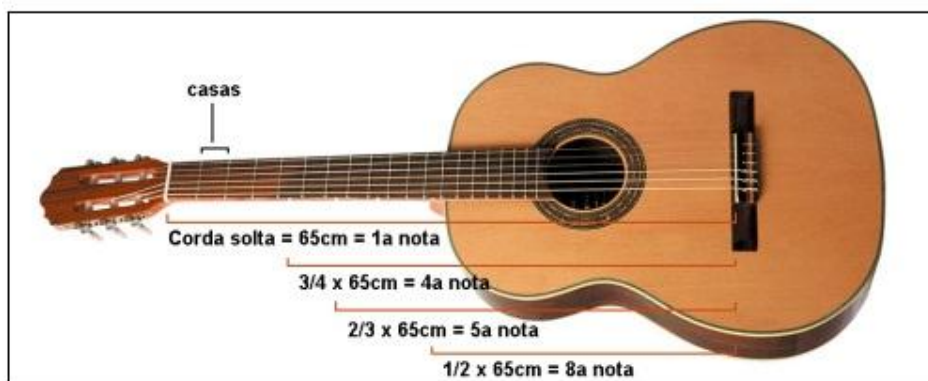
Figura 1.11 – Relação entre o comprimento da corda de um violão e as notas da escala
